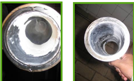
Fotos tiradas do retardador logo após o pré-tratamento e a limpeza alcalina. As camadas de sujidades minerais foram completamente removidas após a limpeza ácida.
